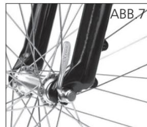
Wenn die Räder mit Schraubmuttern befestigt sind, lösen Sie beiden Muttern der Nabe und nehmen diese gegebenenfalls herunter, um den Bolzen von Sicherheitsscheiben oder anderen Befestigungselementen zu befreien.
