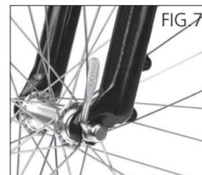
Si les roues sont fixées avec des écrous, desserrer les deux écrous du moyeu et le cas échéant les enlever pour libérer le pivot des rondelles de sécurité ou autres dispositifs de fixation.
