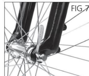
Se le ruote sono fissate con dadi, allentare entrambi i dadi del mozzo ed eventualmente asportarli per liberare il perno da rondelle di sicurezza o altri dispositivi di fissaggio.
